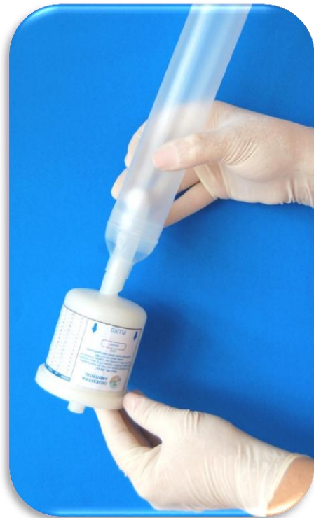
Figura 4 - Faça a drenagem do líquido filtrado diretamente para o frasco de amostragem
