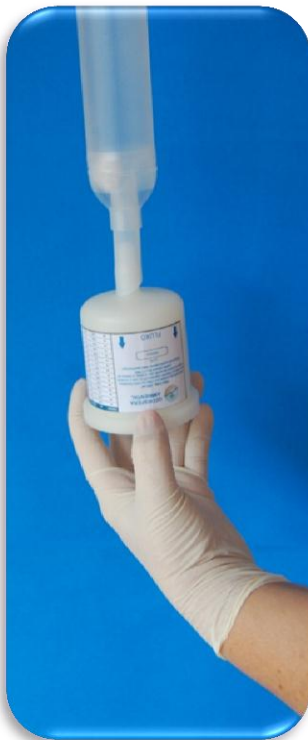
Figura 3 - Insira o bico conectado ao Super Filtro 0,45µ no amostrador
