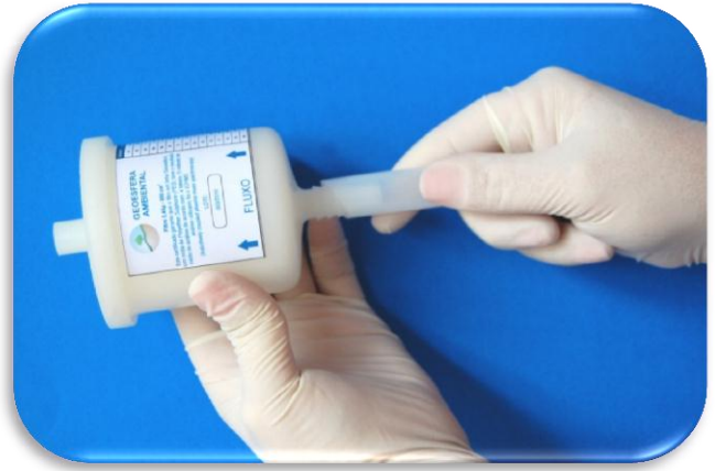
Figura 2 – Conecte o bico ao Super Filtro 0,45µ
