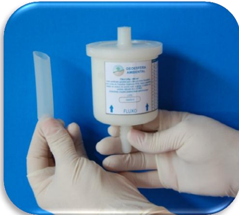
Figura 1 – Bico e Super Filtro 0,45µ
